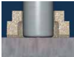
Der Bolzen wird auf das Werkstück aufgesetzt.
